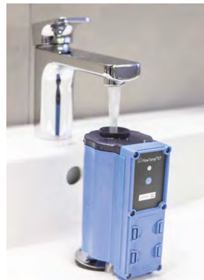
-Figuur 3- Meting van de watertemperatuur met de FlowTemp-ST die de meetwaarden direct overdraagt via Bluetooth Smarttechniek (foto: Euro-Index)
